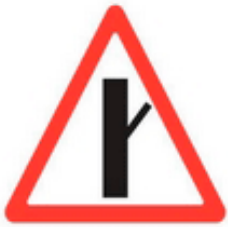
2.3.4 Примыкание второстепенной дороги
