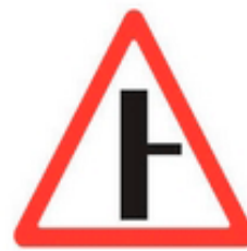
2.3.2 Примыкание второстепенной дороги
